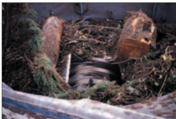
Figura 5.2 - Vista interna di un trituratore a dischi rotanti uncinanti (*hooked cutter disc grinder*), impiegato nello sminuzzamento di residui di potatura.
