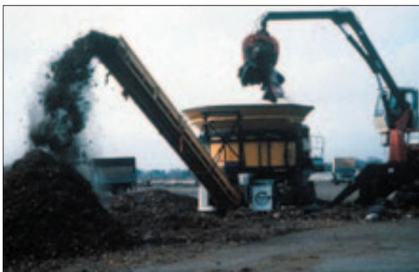
Figura 5.4 - Trituratore a tramoggia rotante, per il condizionamento meccanico dei substrati organici destinati al compostaggio.
