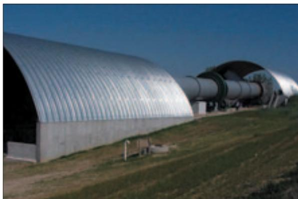
Figura 4.12 - Bioreattore a cilindro orizzontale rotante.
