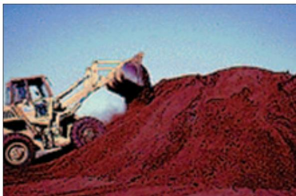
Figura 4.4 - Rivoltamento dei cumuli di materiale in compostaggio mediante pala meccanica con cucchiaio caricatore frontale (FEL/front end loader).
