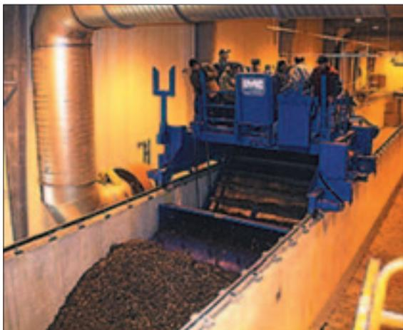
Figura 4.14 - Particolare di macchina rivoltatrice a carroponte per la movimentazione del substrato in fase di compostaggio attivo all'interno di una trincea dinamica aerata.
