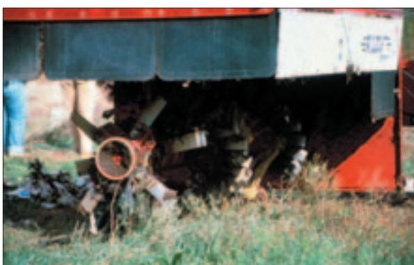
Figura 4.5 - Macchina volta-cumuli azionata dalla presa di forza di un trattore. L'albero fresante movimenta soltanto metà dell'andana.
