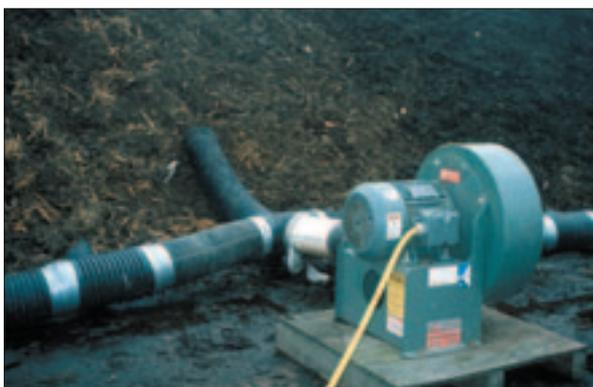
Figura 4.10 - Soffiante per l'immissione di aria nel materiale in compostaggio secondo il sistema dei cumuli aerati per insufflazione.
