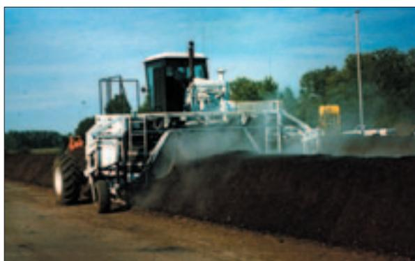
Figura 4.8 - Compostaggio in cumuli aerati mediante movimentazione a mezzo di macchina rivoltatrice semovente.
