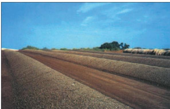
Figura 4.2 - Aia di compostaggio con andane (*windrows*) disposte per il rivoltamento.
