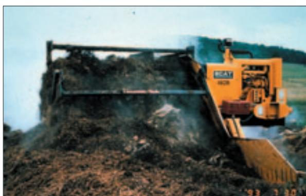
Figura 4.6 - Convogliatore a piano inclinato per il rivoltamento dei cumuli. In alto, è mostrata la macchina allestita per essere trainata da un trattore; in basso, è invece possibile vedere lo stesso tipo di macchina, in versione semovente. In entrambi i casi, la rivoltatrice opera, ad ogni passaggio, soltanto su una metà del cumulo.
