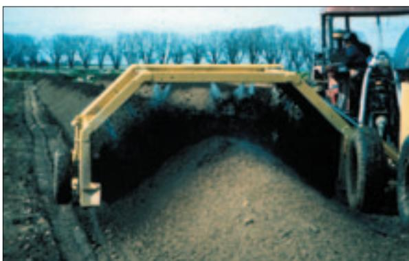
Figura 4.7 - Compostaggio in cumuli aerati mediante movimentazione a mezzo di macchina rivoltatrice trainata, con capacità di lavoro su tutta la larghezza del cumulo.
