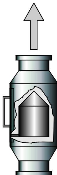
**Figura 16: Separatore magnetico tubolare**
