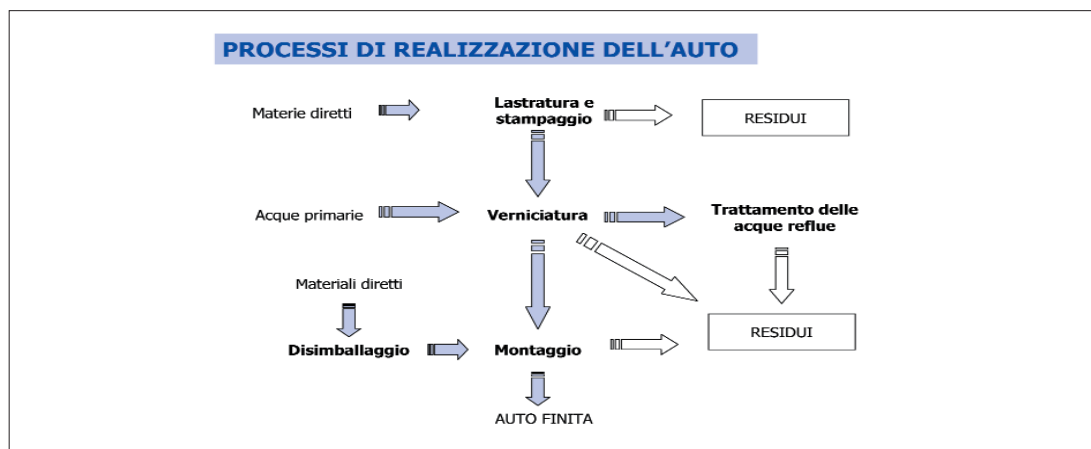
Figura 9.2: Processi di realizzazione dell'auto. Sono evidenziati i processi che generano rifiuti.
